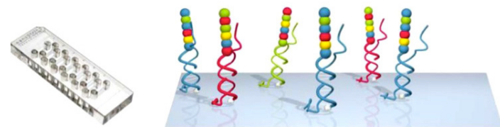
Εικόνα 3: Δέσμευση υβριδοποιημένων ανιχνευτών αναφοράς στην επιφάνεια της φύσιγγας
