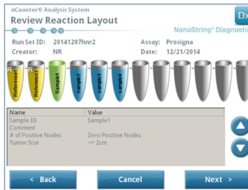
12. Dans les écrans suivants, l'utilisateur sera invité à lire les ID de codes-barres des réactifs demandés dans les champs ouverts ou confirmer le placement des consommables requis sur le plateau. Après l'exécution de chaque tâche, sélectionner Next (Suivant) dans l'interface à écran tactile pour passer à l'étape suivante.
